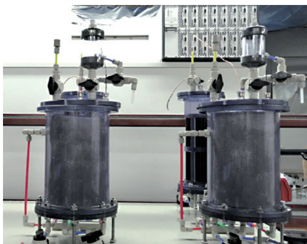
Abb. 3.5: ElektroPapier – Mikrobielle Brennstoffzellen und Elektrolysezellen im Labormaßstab (© TU Braunschweig)
