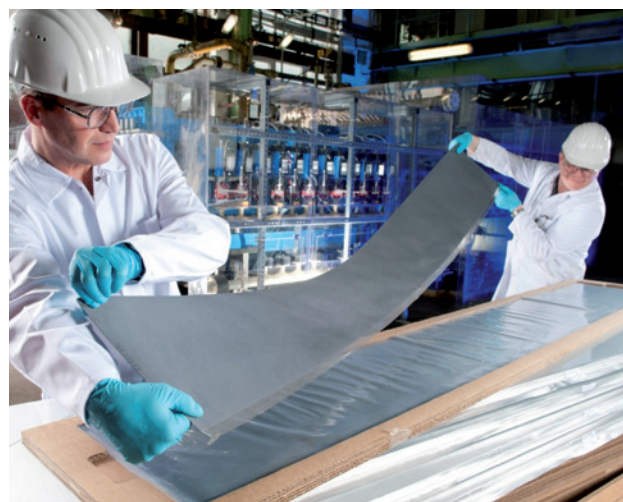
Abb. 3.5: RADAR – Gasdiffusionselektrode (© Covestro Deutschland AG)
