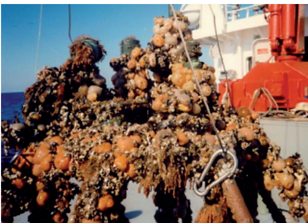
Abb. 3.6: AntiPARAM – Biofouling in offenem Gewässer, Sensorträger mit Sensorik für Leitfähigkeit, Druck, Strömung und Temperatur nach 6-monatigem Einsatz in der Nordsee vor Sylt (© 4H-JENA engineering GmbH)
