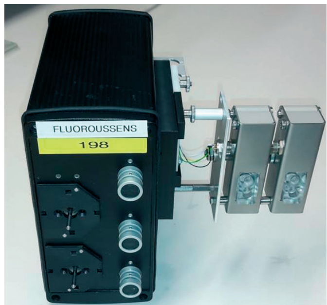
Abb. 2: Funktionsmuster mit zwei Messkammern ©M. Hartlep, 2018
