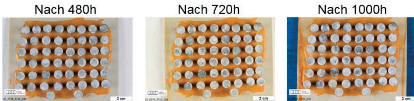
Abb. 4: Ergebnis Salzsprühnebeltest 36 AlCr-Multilagen Beschichtung [©Audi], M. Neubauer
